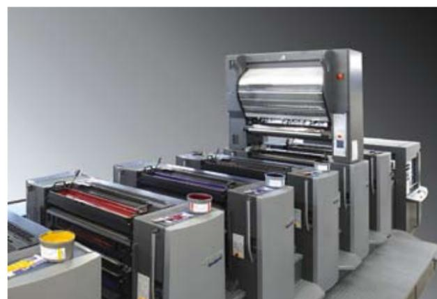
Bei dieser Heidelberg CD 102-6+LX2 der Druckerei Nastro&Nastro, Germignaga (I), werden für das Coldfoilverfahren zwei zusätzliche Werke gebraucht. Das erste Werk trägt den Klebstoff auf, im zweiten Werk wird die Metallicfolie zugeführt, die an den mit Klebstoff versehenen Stellen haftet. Infos: [www.nastroenastro.it](http://www.nastroenastro.it). Coldfoil-Manual oder Mustermappe gratis anfordern: [manuel.borgia@nastroenastro.ch](mailto:manuel.borgia@nastroenastro.ch).
