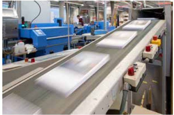
Im Klebebinder werden Umschlag und Inhalt zusammengefügt.
