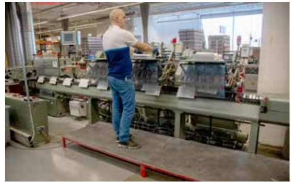
Im Sammelhefter werden die einzelnen gefalzten Druckbogen zusammengetragen.
