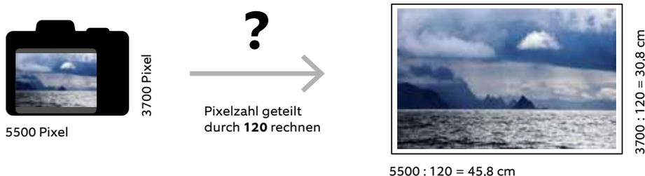
Die Anzahl Pixel der Kamera ist für den Skalierungsfaktor massgebend. 20 Megapixel heisst zum Beispiel, dass ca. 5500 × 3700 Pixel auf die Karte geschrieben werden (siehe Tabelle nächste Seite). Rechnet man die Pixelzahl jeder Seite geteilt durch 120, ergibt sich die optimale Bildgrösse in cm, die abgebildet werden kann. Hier also 45,8 × 30,8 cm. Dies ist die «physische» Grösse, die optimale Voraussetzungen bietet. Die Druckdatei hat dann eine Auflösung von 300 ppi.
