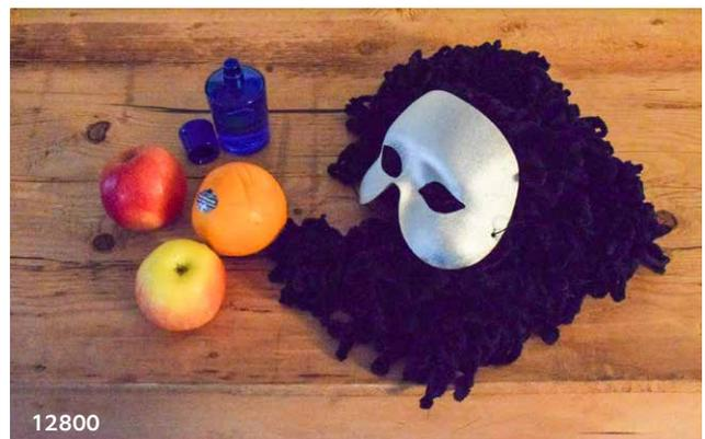
Die DX-Kamera Nikon D5300 ermöglicht Abbildungsgrößen von 50×33 cm bei 300 ppi. Hier sind die Bilder rund sechsmal kleiner in der Größe 8,3×5,3 cm wiedergegeben. Bei dieser Kamera wird deutlich, dass sich das Farbverhalten mit dem ISO-Wert verändert. Die dunklen Schwarztöne erhalten einen starken Blaustich.
