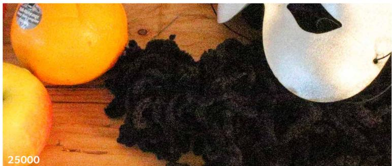
Ein Vergleich zwischen 800 und 25000 ISO macht die Unterschiede deutlich. Mit zunehmendem Bildrauschen ist ein Schärfeverlust verbunden, der in den feinen Strukturen der Maske oder bei der Schrift der Etikette sichtbar wird.
